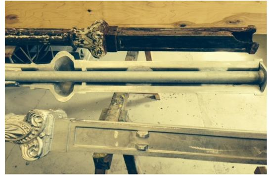
Diese durch Korrosion und Frostschäden stark beschädigte Eisen-Guss-Säule wurde von uns im Aluminium Sandgussverfahren nachgefertigt.
